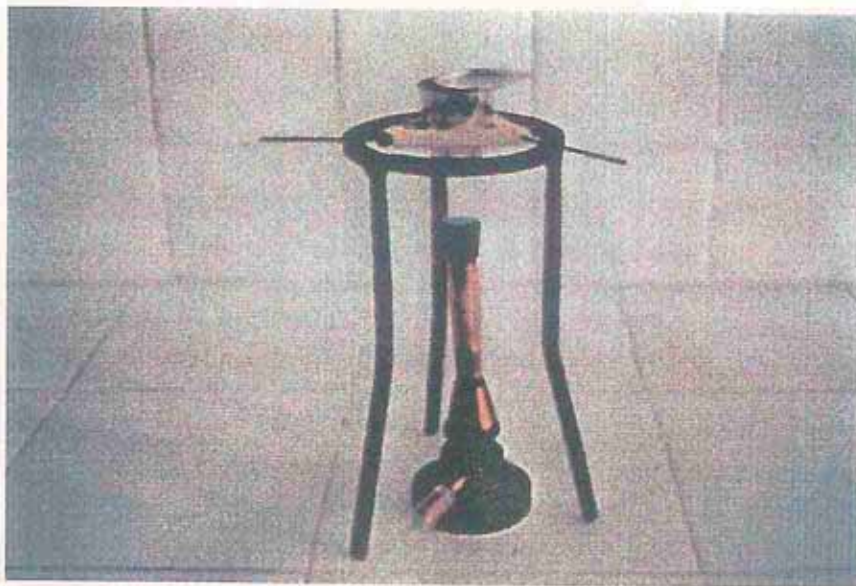
รูปที่ ก4 ภาพแสดงลักษณะการใช้เบ้าทองคำขาวขณะเผาตะกอน คัดลอกจาก นิภา จุละจาริตต์ และธีรานิ โชติกไกร (2539)
