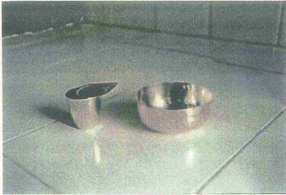
รูปที่ ก1 รูปร่างลักษณะของเบ้าและถ้วยทองคำขาว คัดลอกจาก นิภา จุละจาริตต์ และธีรานี โชติกไกร (2539)
