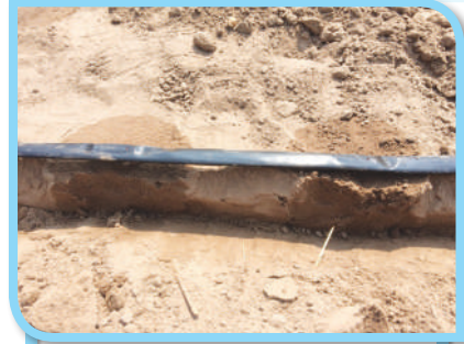
รูปที่ 8 ลักษณะการซึมลึกของน้ำ จากเทปน้ำหยด
