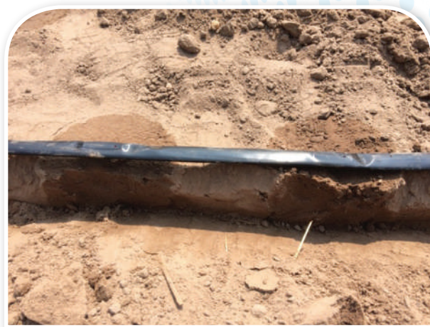
ภาพที่ 58 ลักษณะการซึมลึกของน้ำจากเทปน้ำหยด
