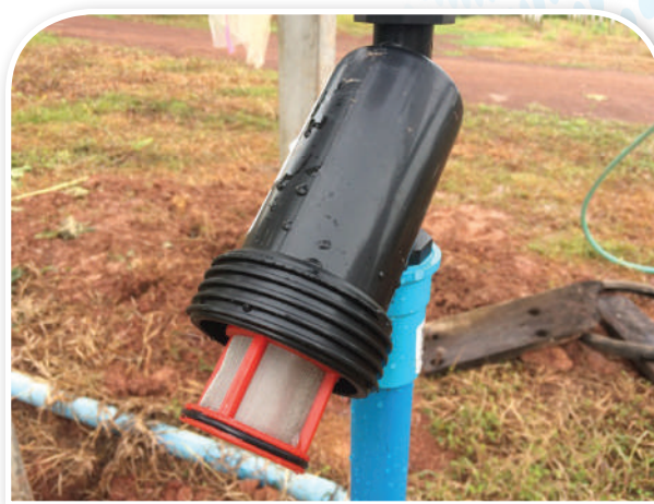
ภาพที่ 41 กรองเกสรแบบตะแกรง ใส้กรองสีแดงความละเอียด 120 Mesh
